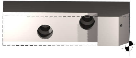
Nullpunkt G55 an der Rohteilkante unten bei Stellung 45 Grad 45 Grad-Fläche und Bohrung 3
