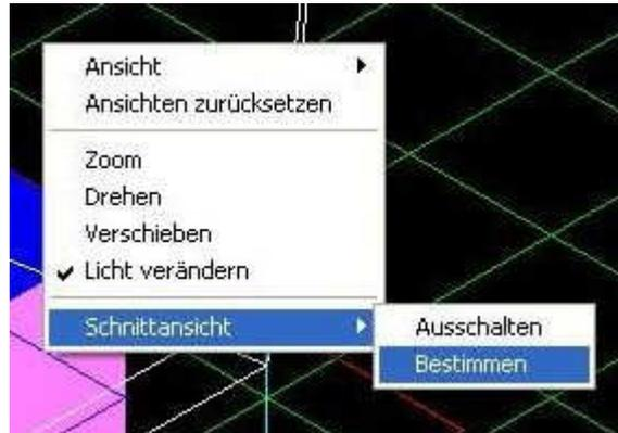
Bei eingeschalteter Schnittansicht können mit „Bestimmen“ die Parameter für die Schnittdarstellung verändert werden.
