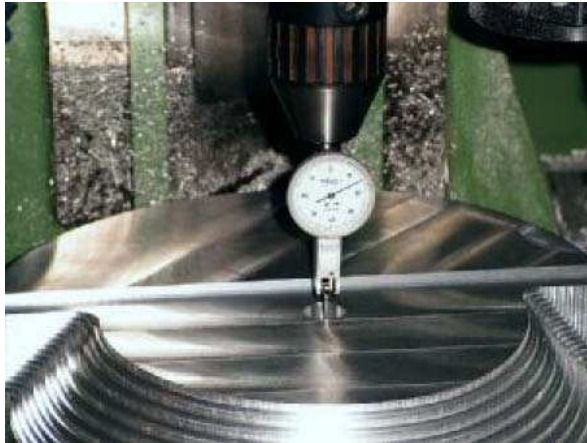
Ausmessen des Nullpunkts für die zweite Hälfte
