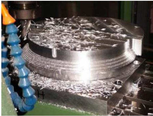
Stufen der ersten Hälfte fräsen
