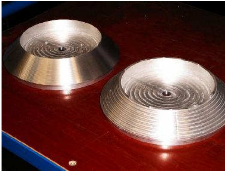
Gefräster und fertig gedrehter Ring
